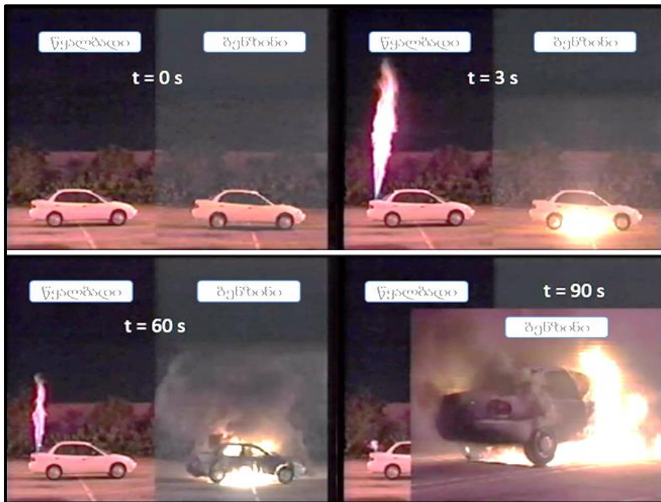
საწვავის ავზის აფეთქებით გამოწვეული შედეგები წყალბადსა და ბენზინზე მომუშავე ავტომობილების შემთხვევაში
