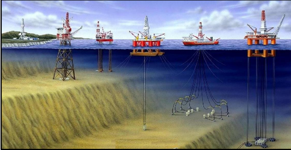
ნავთობმომპოვებელი ჭაბურღილების სახესხვაობების შერჩევა წყლის სიღრმის გათვალისწინებით 99
